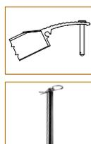
**Stahlzapfen (auf Wunsch):** Über die Öffnungen im Standardkopf der Rampe und in der Ladefläche kann ein verzinkter Stahlzapfen mit einem Durchmesser von 14 mm und einem Kopf mit 24 mm Durchmesser eingesetzt werden.
