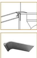
**Aluminiumlasche (Standard):** Dieses Verankerungssystem hat den Vorteil, dass die Lasche über einen Großteil der Rampenbreite verschoben werden kann und sich im Kopf, in den sie zuvor eingesetzt wurde, drehen kann. Es werden eigene Verschlussdeckel für den Kopf mitgeliefert, damit die Lasche während der Verwendung nicht aus der Rampe rutscht.
